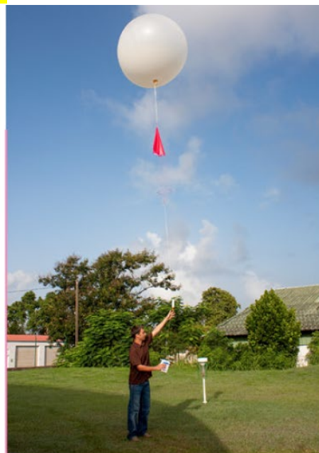
FIG. 1 Le ballon sonde est rempli à l'hélium, un gaz plus léger que l'air et inerte chimiquement.
